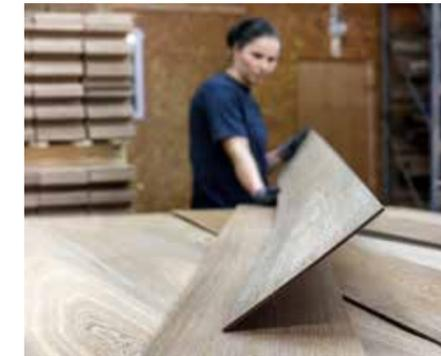
Endsortieren der Decklagen: Das menschliche Auge entscheidet.
