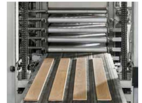
Verpressen der drei spannungsfreien Massivholzschichten.
